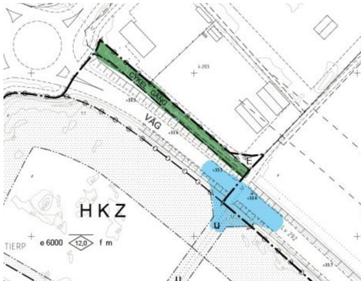
Blått område visa tänka trafiklösningar för biltrafik medan grönt område visar tänkt sträckning för G/C-vägar.
